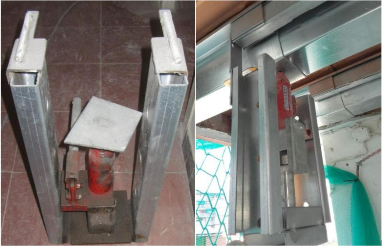
Figure 16 - Outils de pré-fléchissement de porte-à-faux
